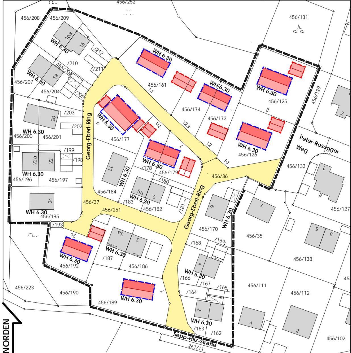
Die zulässige **Wandhöhe WH** [m] als Höchstmaß, wird traufseitig gemessen von Oberkante Fertigfußboden Erdgeschoss (OK.FFB.EG) bis zum Schnittpunkt der senkrechten Außenwand mit der Oberkante der Dachhaut.
