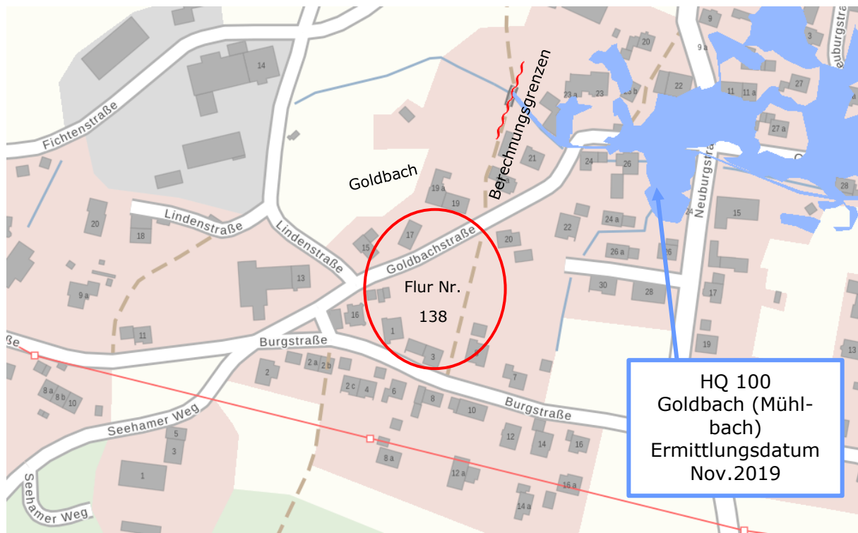
Abb. 6 Darstellung der Hochwasser-Gefahrenfläche HQ 100 mit Darstellung des Planungsgebietes (schematisch rot umrandet) - ohne Maßstab
