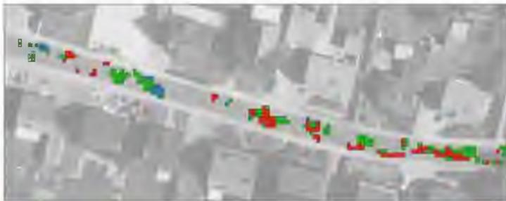
Abbildung 7: Beispiel Visualisierung von Rissen (rot), Flickstellen (grün) und sonstige Oberflächenschäden (blau)
