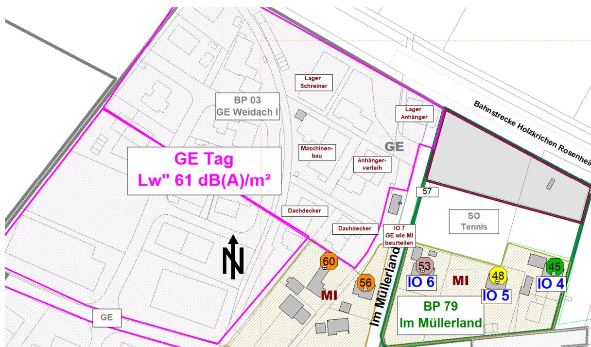
Mit Berücksichtigung der Vorbelastung ist mit der in Abbildung 8 dargestellten Gesamtbelastung (inkl. Glascontainer) an IO 4 bis IO 7 zu rechnen.
