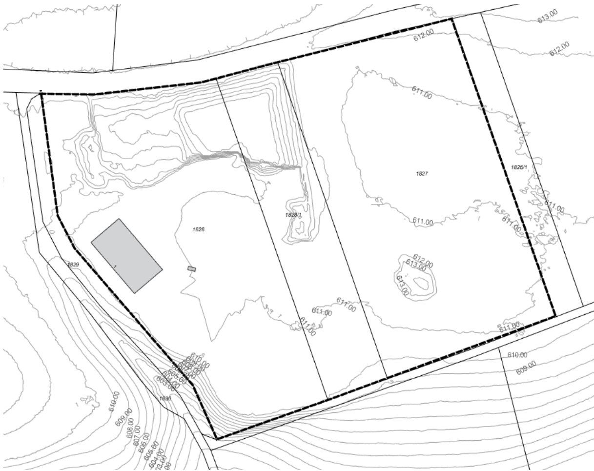
Abb. 5 Karte Topographie mit Darstellung der Höhenlinien im DGM1 und Kennzeichnung des Änderungsbereichs (schwarze Blockmarkierung) ohne Maßstab
