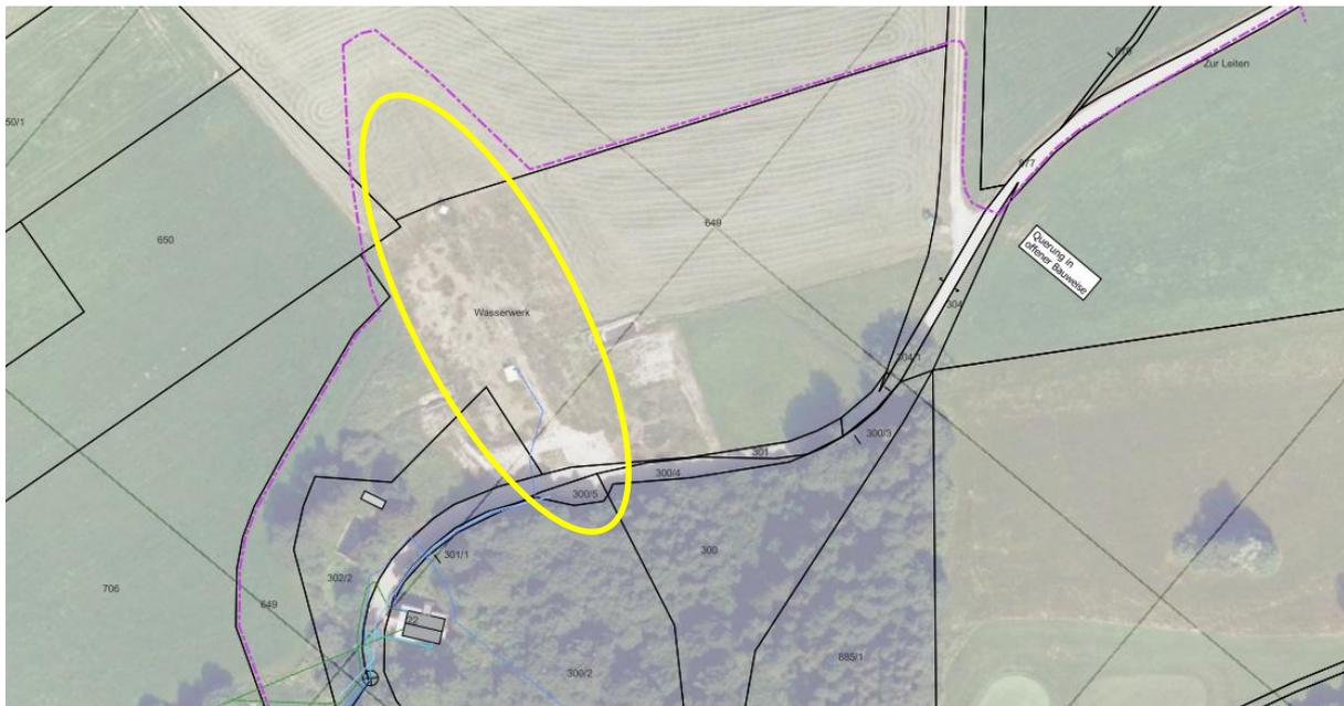
Abb. 19 Auszug aus dem Lageplan zur Anbindung des geplanten Solarpark mittels 20kV-Kabelleitung (MSP, lilafarbene Linie) im Umfeld des Beckens 1 „Leiten“ (schematisch gelb umrandet) – ohne Maßstab
