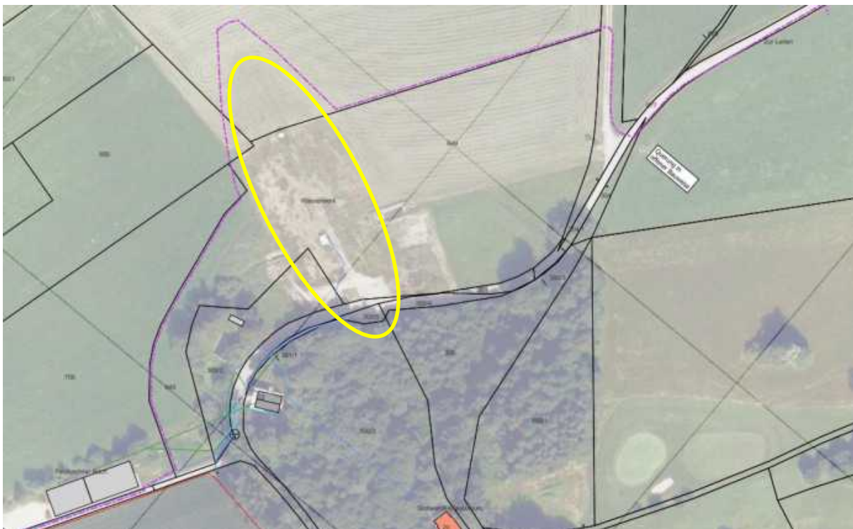
Abb. 20 Auszug aus dem Lageplan zur Anbindung des geplanten Solarpark mittels 20kV-Kabelleitung (MSP, lilafarbene Linie) im Umfeld des Beckens 1 „Leiten“ (schematisch gelb umrandet) – ohne Maßstab
