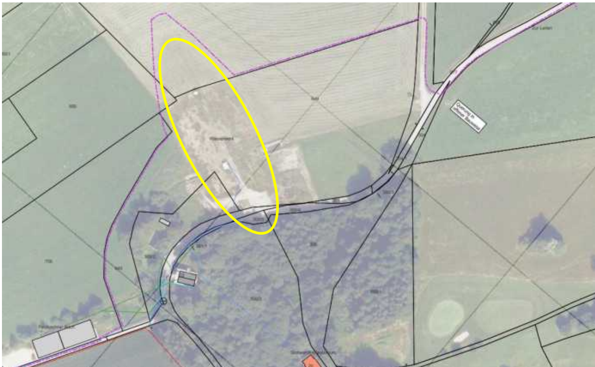
Abb. 4 Auszug aus Lageplan zur Anbindung des geplanten Solarpark mittels 20kV-Kabelleitung (MSP, lilafarbene Linie) im Umfeld des Beckens 1 „Leiten“ (schematisch gelb umrandet) – ohne Maßstab
