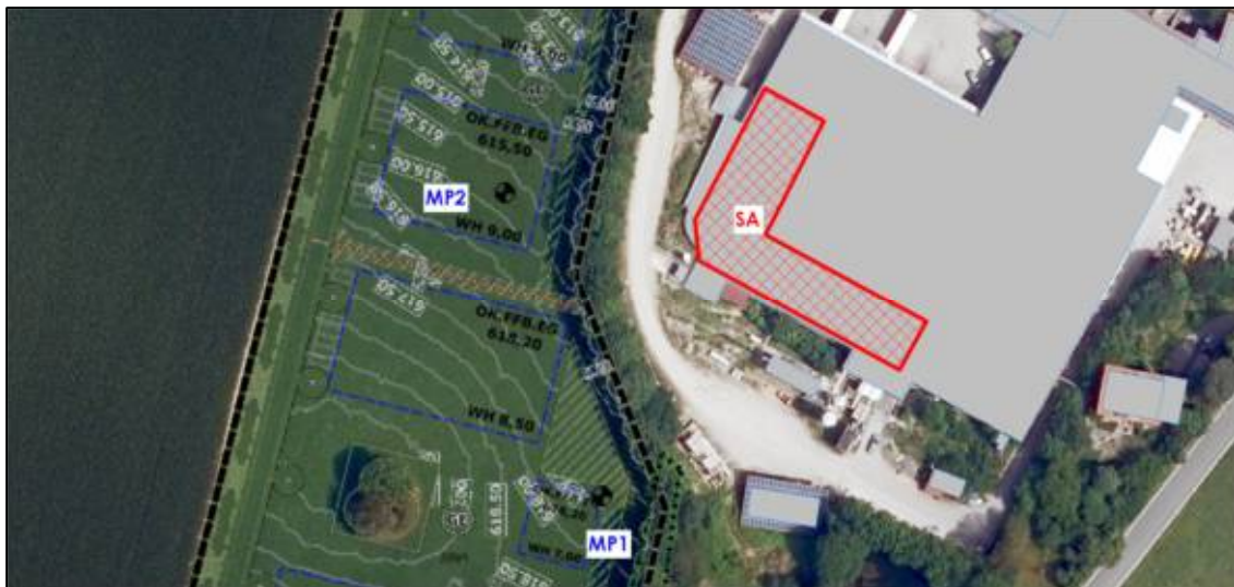
Abbildung 9: Luftbild /26/ mit Eintragung der Baugrenzen /23/, Messpunkte und Schallquelle SA
